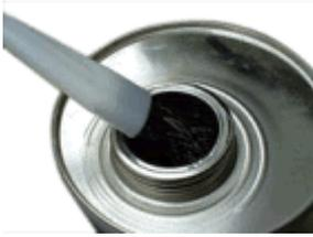
接着剤のキャップを開けると、写真の様なハケが付いているので、そのまま塩ビ管の差し込む方に、指し込み代<sup>しろ</sup>からはみ出ない様に塗ります。
