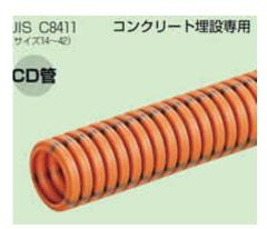
コンクリート埋設専用ですので電線菅として他では使用できません。安い素材で燃えやすい(自消性がない)ためです。よって×です。
